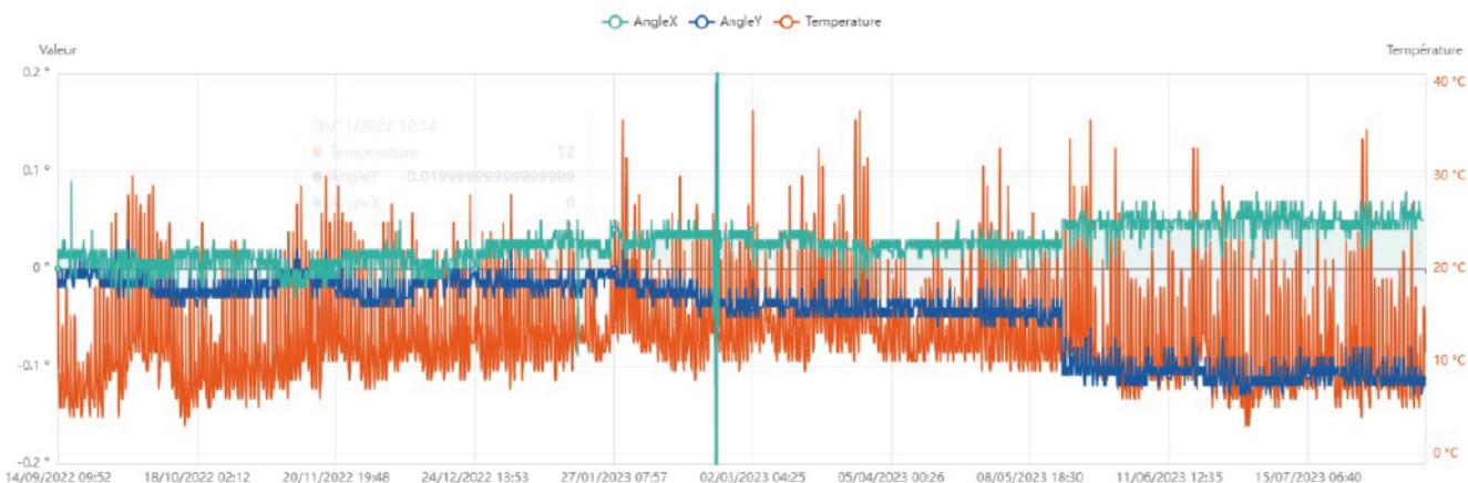
Les conditions de surveillances ont été particulières : le capteur DELTA R était immergé lors de la marée. Cependant, grâce à sa coque avec protection IP66, le DELTA R a continué de fournir les données nécessaires.
